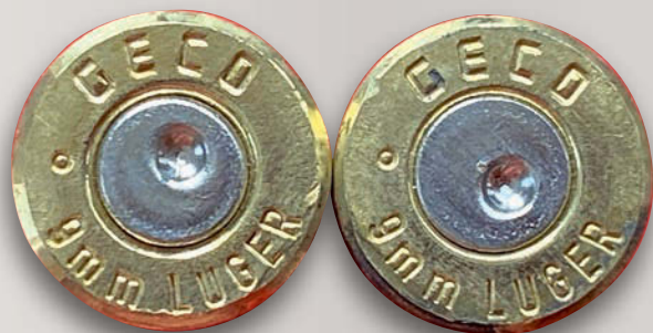
Den Unterschied zwischen dem niedrigsten und höchsten Gasdruck von rund 600 im Mittel bar macht sich sichtlich bemerkbar. Das Zündhütchen rechts füllt mehr von der Ringfuge aus und auch der Schriftzug auf der Hülse wird langsam geplättet. (Bild: Tino Schmidt)
