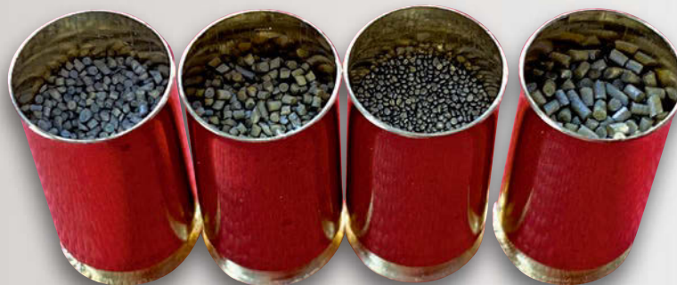
Die Füllstände sind bei all unseren „Major“-Handladungen fast identisch und werden allesamt beim Geschossetzen gepresst. Von links: Swiss Reload RS 24, Vihtavuori 3N38, Lovex D037.1 und Vihtavuori N105. (Bild: Tino Schmidt)
